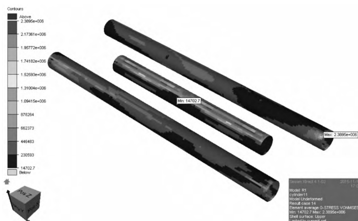
图 9 筒体结构总横强度等效应力云图
