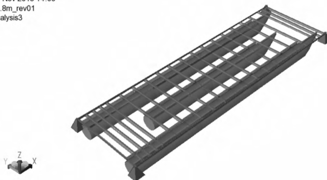
图 5 总纵强度边界条件施加示意图
